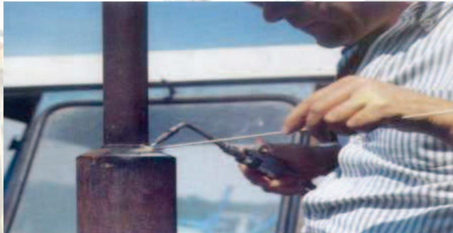
Reparação de um tubo de escape de um tractor através da brasagem sem qualquer preparação prévia, com a vareta MICROFLUX.
