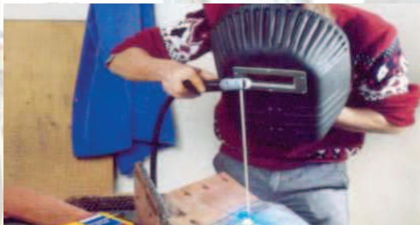
Tratamento de proteção às bordas de um tractor, com ManTech E310.
