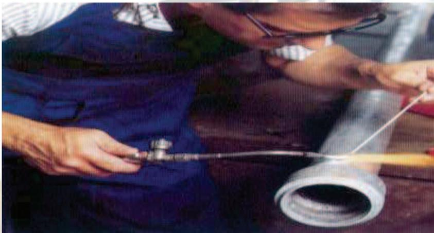
Reparação de um tubo de irrigação através da brasagem, com ManTech 821F.
