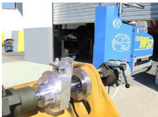
Reacondicionamento e realinhamento de orifícios, braços e carregadoras com rodas.
