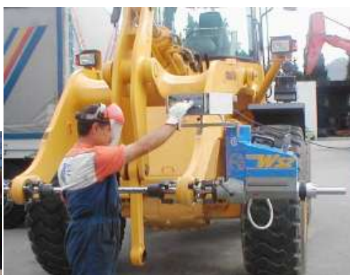
Reacondicionamento e realinhamento de orifícios, braços e carregadoras com rodas.
