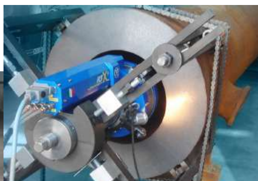
Suporte autocentrado com expansão pneumática.
