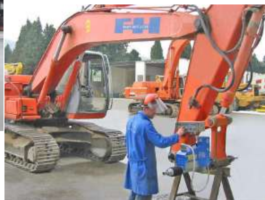
Reacondicionamento e realinhamento de orifícios, braços e carregadoras com rodas.
