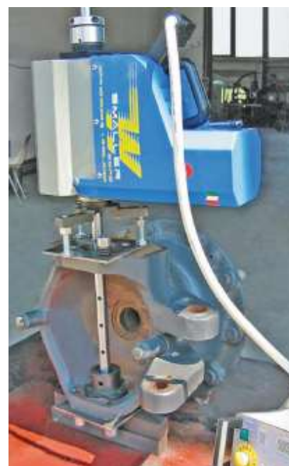
Renovação do alojamento do eixo rotativo.
