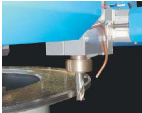
Maquinagem externa através de cortadores cilíndricos.
