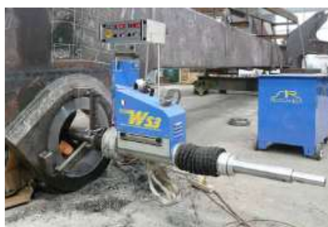
Recondicionamiento do alojamento de buchas Crusher 420mm com uso suporte de expansão autocentrante.
