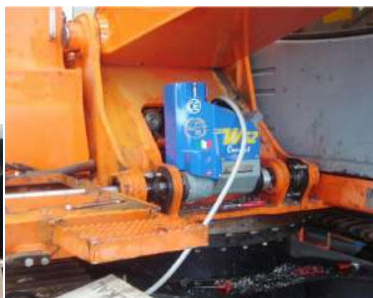
Restauração suporte para os cilindros, elevação do braço das escavadoras sem retirar a cabine. Nas novas máquinas, desmontar a cabine em fase de rastreio, pode trazer complicações graves sobre os aparelhos eléctricos e electrónicos.
