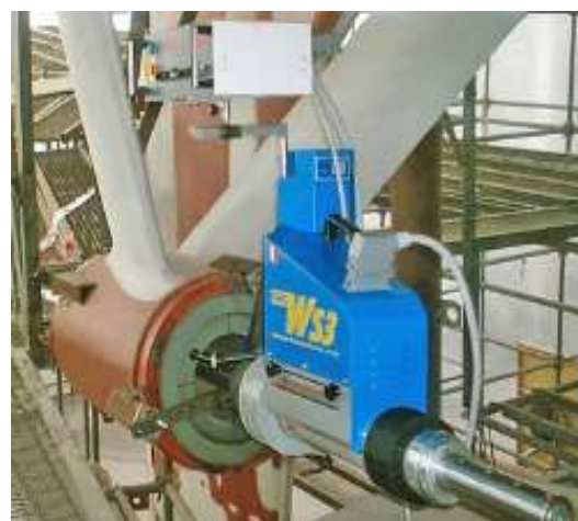
Recuperação de barbatanas estabilizadoras de um navio.
